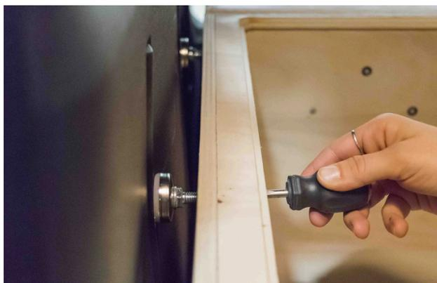
11. Utilisez un tournevis à tête plate pour ajuster les patins de nivellement jusqu'à ce que le module central soit fermement appuyé contre les parois du véhicule. Cela permet de garantir que le kit de conversion reste bien en place.
