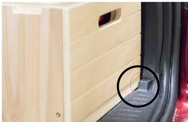
5. Assurez-vous que l'avant des boîtes arrière de cuisine soit bien appuyé contre le hayon du véhicule. Pour ce faire, fermez le hayon et poussez le kit vers celui-ci jusqu'à ce qu'il repose fermement contre la porte fermée. Cela permettra de positionner correctement la boîte centrale.
