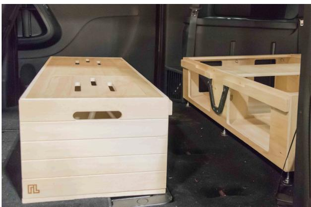
6. Insérez la banquette avant dans le véhicule. Alignez-la avec le module central. *Si vous êtes en mode solo, placez la demi-banquette du côté où vous avez fixé le support en U sur le module central.*
