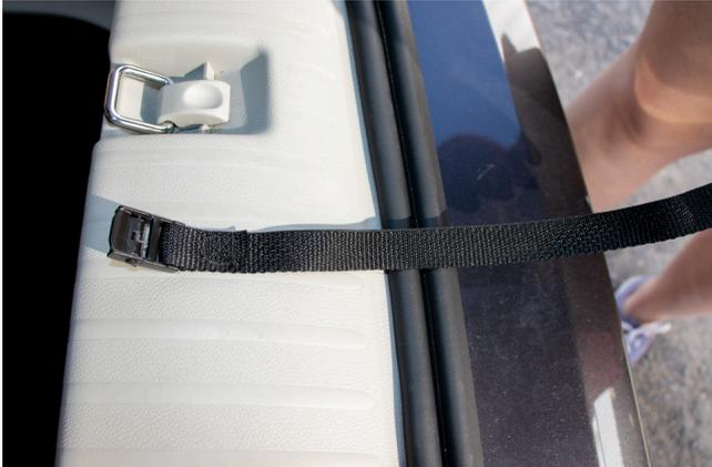
1. Installez les sangles de fixation des tiroirs dans l'ancrage à l'arrière du véhicule. Assurez-vous qu'elles soient dans le bon sens.
