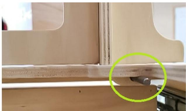
4. Verrouillez la patte en insérant la goupille conique dans le trou depuis l'intérieur de la boîte. (La goupille conique a une petite extrémité et une grande extrémité, insérez la petite extrémité dans le trou.) La patte est maintenant sécurisée et devrait rester en place lorsque vous soulevez l'unité de tiroirs.
