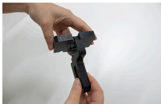
Pour ce faire, insérez les crochets de la pièce C dans le trou central de la pièce D.
