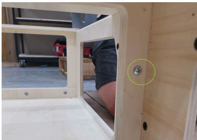
2. Assemblez les boîtes en insérant la vis depuis l'intérieur du module central. Assurez-vous d'insérer la vis dans la boîte qui ne comporte pas de pièce noire. Répétez cette opération de l'autre côté.
