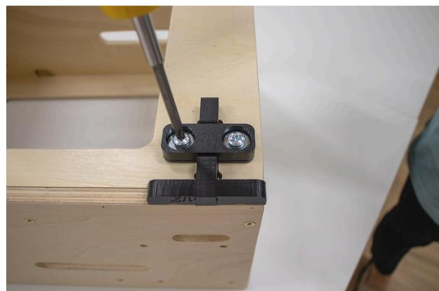
3. Fixez la pièce C sur le dessus de la pièce A. Utilisez une vis et une rondelle par trou.
