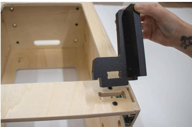
2. Insérez les pièces assemblées A et B dans les fentes désignées sous la banquette.
