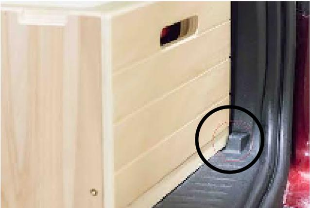
6. Assurez-vous que l'avant des boîtes arrière de cuisine soit bien appuyé contre le hayon du véhicule. Pour ce faire, fermez le hayon et poussez le kit vers celui-ci jusqu'à ce qu'il repose fermement contre la porte fermée. Cela permettra de positionner correctement la boîte centrale.
