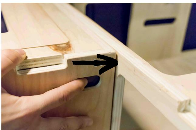
4. Verrouillez les boîtes en place en faisant glisser les loquets des tiroirs vers le module central.
