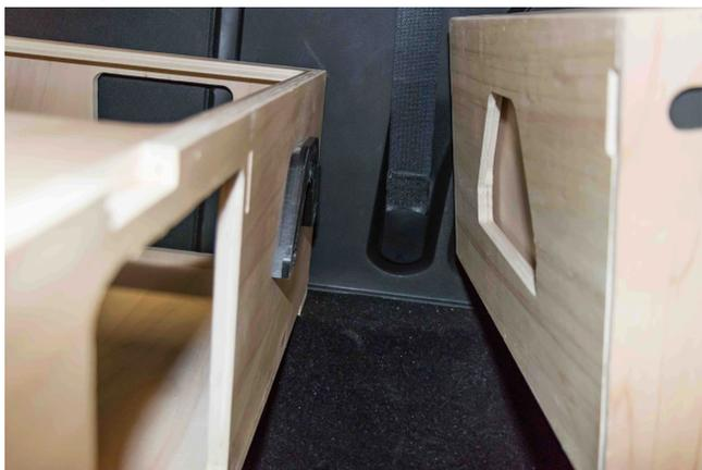
3. Insérez les deux boîtes arrière ( tiroir pour l'évier et tiroir pour le réchaud) dans le système de fixation du module central.
