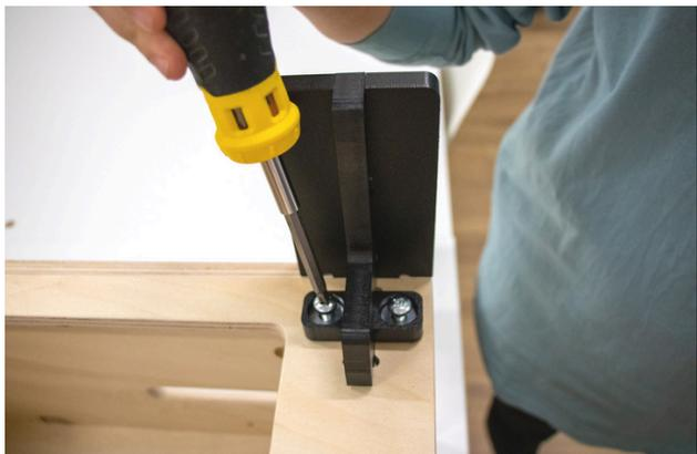
3. Insérez la pièce E dans le trou de la pièce B, en vous assurant de l'aligner avec les trous pour les vis.
