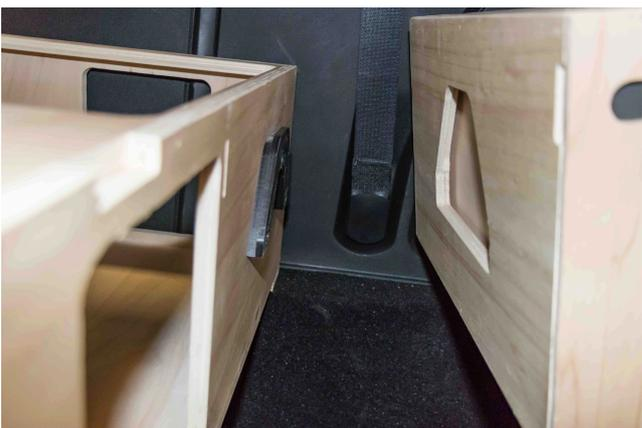
4. Insérez les deux boîtes arrière (tiroir pour l'évier et tiroir pour le réchaud) dans le système de fixation du module central.
