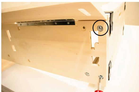
5. À l'aide d'un tournevis étoile, fixer le petit caisson à la pièce de liaison. Pour ce faire, déposer le caisson face au sol sur une couverture propre pour éviter les bris.
