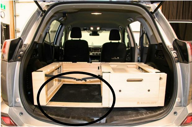
6.3 Emboîter la pièce E sous les deux pattes avant des caissons, puis attacher les sangles de fixation caisson.
