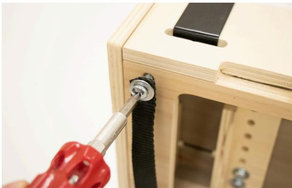
4.1 À l'aide du tournevis étoile, fixer les 2 sangles de fixation aux caissons (une à l'intérieur du petit caisson et une à l'intérieur du caisson cuisine, près des façades).
