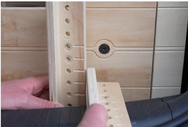
2. Vérifier à l'aide d'une patte la hauteur minimum requis pour l'ouverture du kit, en mettant une patte dans la partie profonde du véhicule, au bord du coffre.
