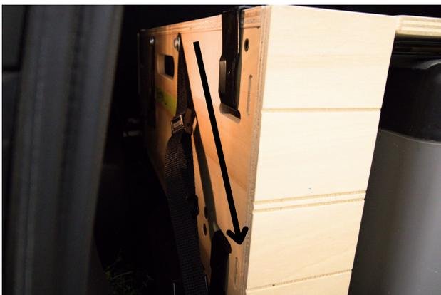
6.5 Serrer les quatre sangles qui se trouvent sur les points d'ancrage du véhicule. Les sangles doivent être en angle comme celle dans l'image. De cette manière, le petit caisson et le caisson cuisine ne bougeront pas et seront sécurisés.
