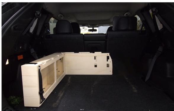
6. Installer le petit caisson et la pièce de liaison dans le véhicule.
