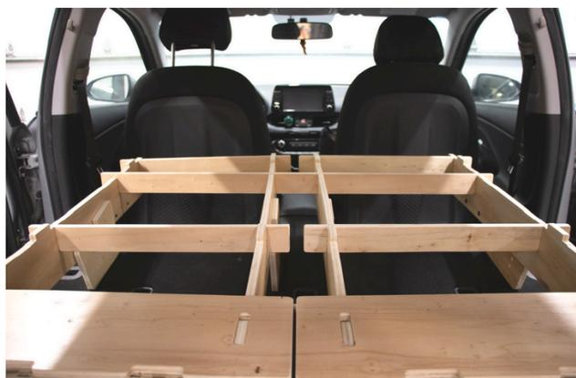
7.2 Emboîtez les 4 travers dans les encoches des longerons. Deux au bout du lit, près des sièges et deux près de la pièce de liaison.
