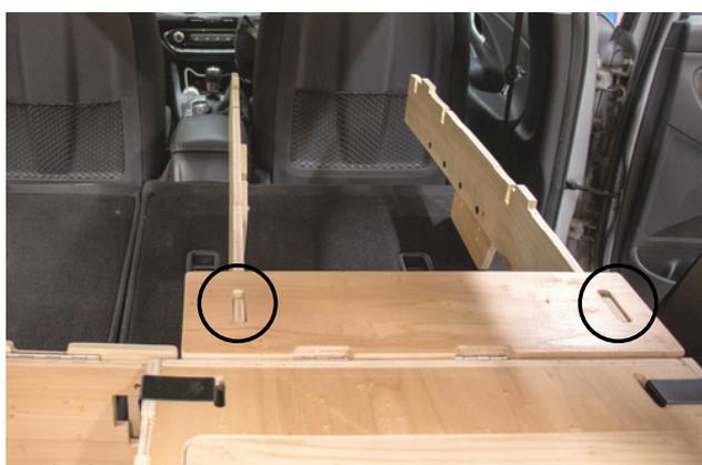
7.2 Emboîter les encoches des longerons dans la partie mobile de la pièce de liaison.
