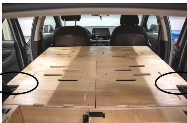
Assurez vous de placer les panneaux avec les crochets vers la cuisine. La plateforme de lit élargie donc au dessus des sièges.
