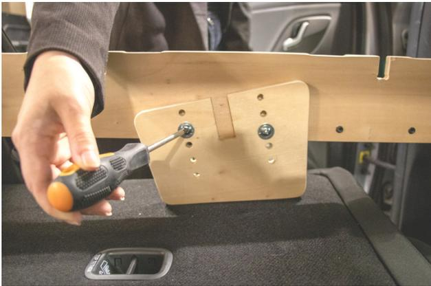
6.3 À l'aide d'un tournevis étoile, installer et ajuster la hauteur des pattes du module de lit.
