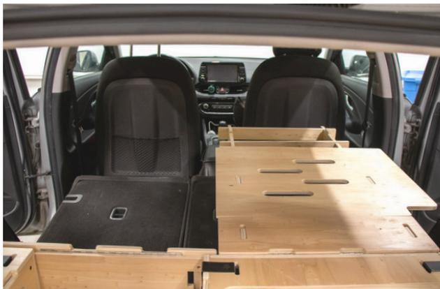
10. Installer les 2 panneaux composant le module de lit. Pour ce faire, installer le premier panneau dans les encoches des longerons.
