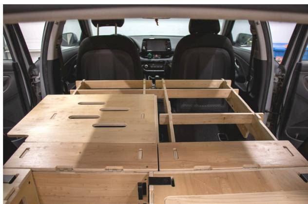
9. Installez les 4 panneaux composant la base de lit. Pour ce faire, installez les panneaux dans les encoches des longerons.
