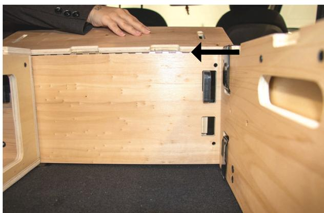
7.1 Emboîter la partie dentée du longeron dans la longue fente de la pièce de liaison. Déplacer la pièce latéralement dans la plus petite fente de façon à barrer le longeron.
