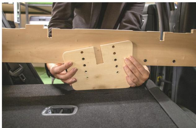
8. Assurez-vous que le module de lit et les caissons sont à niveau. Réajuster les pattes au besoin.
