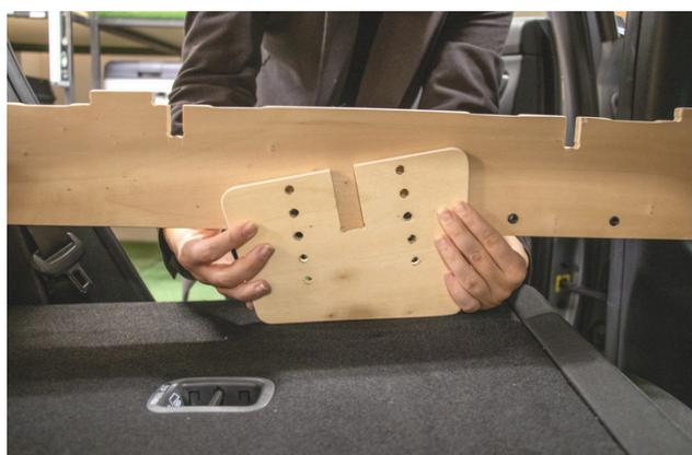
9. Assurez-vous que le module de lit et les caissons sont à niveau. Réajuster les pattes au besoin.
